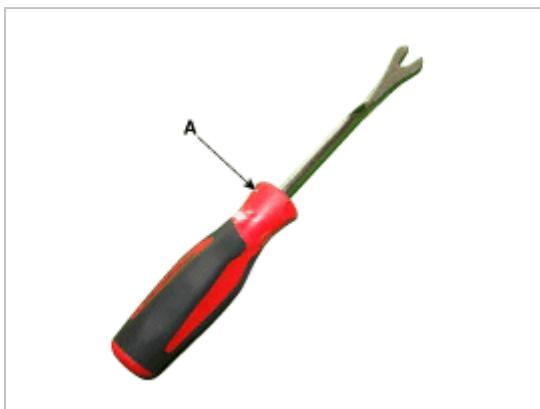
(2) 略微举起前立柱装饰板并插入工具，拉动拆卸固定夹(A)。
